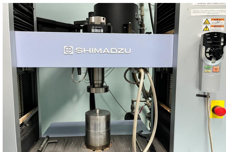
Рисунок 7 – Напольная испытательная машина Autograph AG-X 100 kN, фирмы «Shimadzu GmbH»
