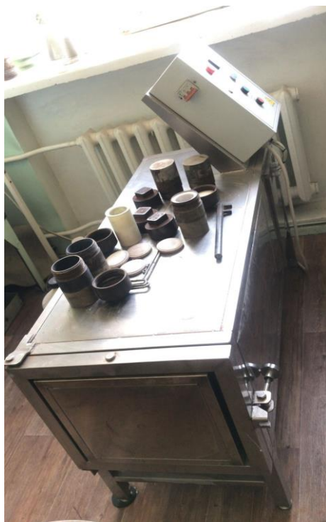
Рисунок 6 - Установка для активации фосфорного шлака
