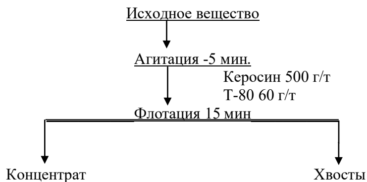
Рисунок 15 – Схема флотации, опыт №1
