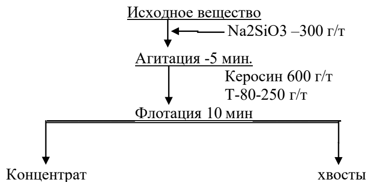
Рисунок 17 – Схема флотации шунгита - образец №3
