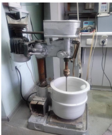
Рисунок 46 - Установка для сорбции урана в статическом режиме.
